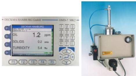
OMD-7MKII的测量原理为国际上知名的红外折射光测量方法。使用多个不同波长的光源及许多不同角度的固态式光接受器来监测颗粒及油滴所产生的不同折射光及透光强度，光能经由放大器及信号转换器转成数字信号，在经由微处理器分别计算出油份含量及颗粒含量，同时亦可计算样品浊度含量。
